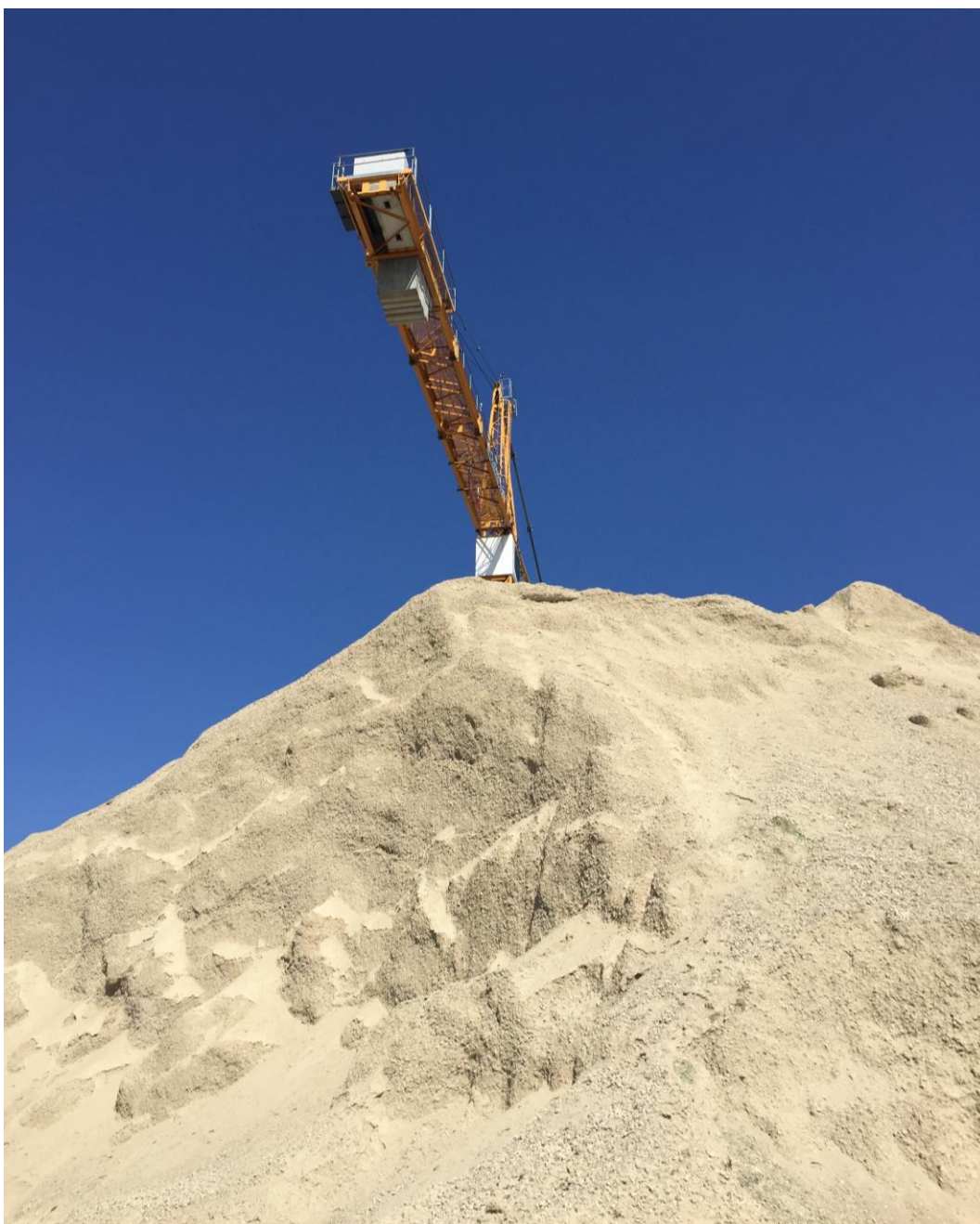
Granulats concassés en attente d'être recyclés à Châtenay-Malabry. Source : Martial Vialleix Institut Paris Region
