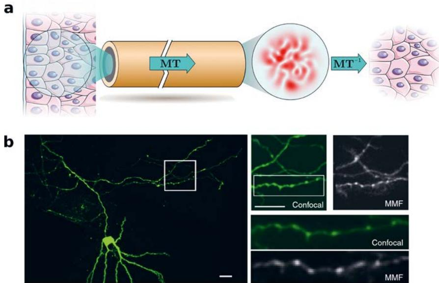
**Figure 4 :** Imagerie et télécommunication dans les fibres optiques multimodes. **a.** Principe de la reconstruction d'image à travers une fibre optique multimode. Après caractérisation de la MT, on inverse l'effet de la propagation à partir de la mesure du champ en sortie de la fibre. **b.** Exemple d'images de neurones à travers une fibre multimode. Image adaptée de [S.A. Vasquez-Lopez et al., *Light Sci. Appl.*, **7**, 110 (2018)].
