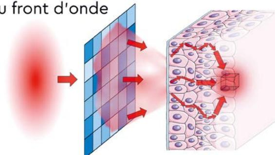
**Figure 3** : Concept de la focalisation en profondeur. Il est nécessaire d'avoir une «étoile-guide» non-invasive pour pouvoir guider la lumière en profondeur. De multiples méthodes (utilisant l'acoustique ou la fluorescence) ont été proposées.
