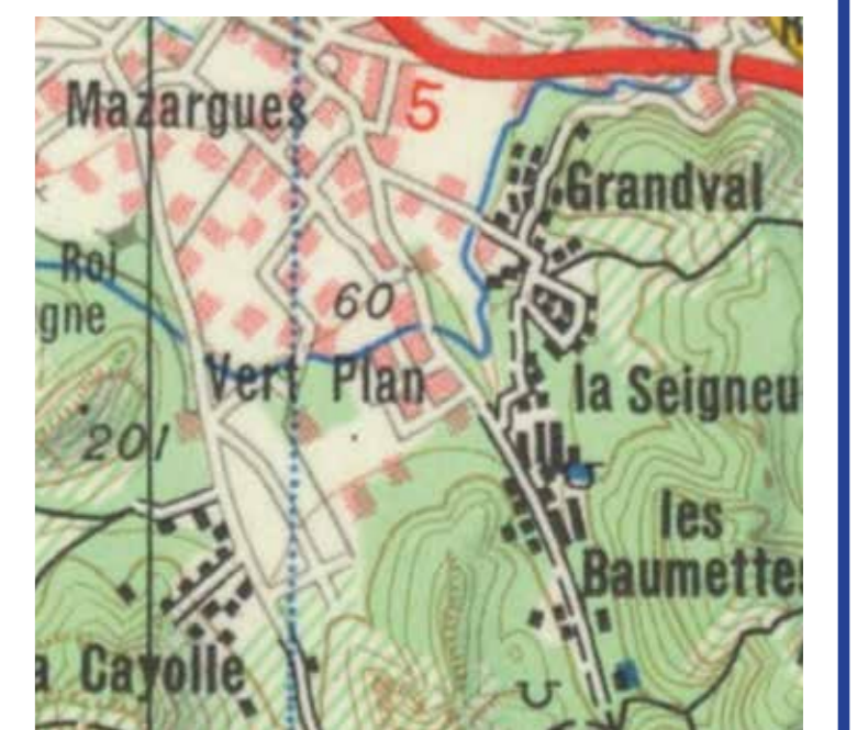
Carte topographique 1:100 000, feuille 023, IGN 1958. Signes différents pour représenter la même information : les zones bâties sont roses et noires.
