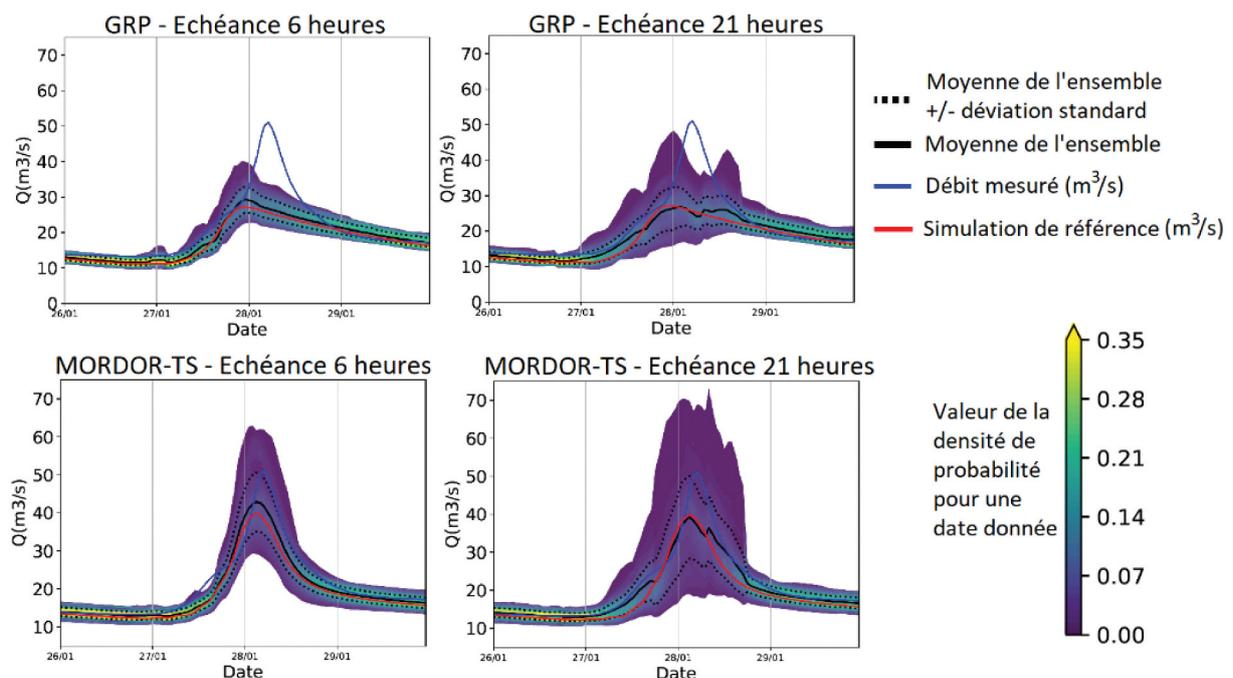
**Figure 5.** Chroniques de débits pour les modèles GRP et MORDOR-TS à la station Tréodet pour l'événement du 26/01/2016 au 30/01/2016 La courbe bleue représente la mesure et la courbe rouge la simulation avec le modèle calé. Une coupe verticale à une date donnée représente la densité de probabilité de la prévision.
