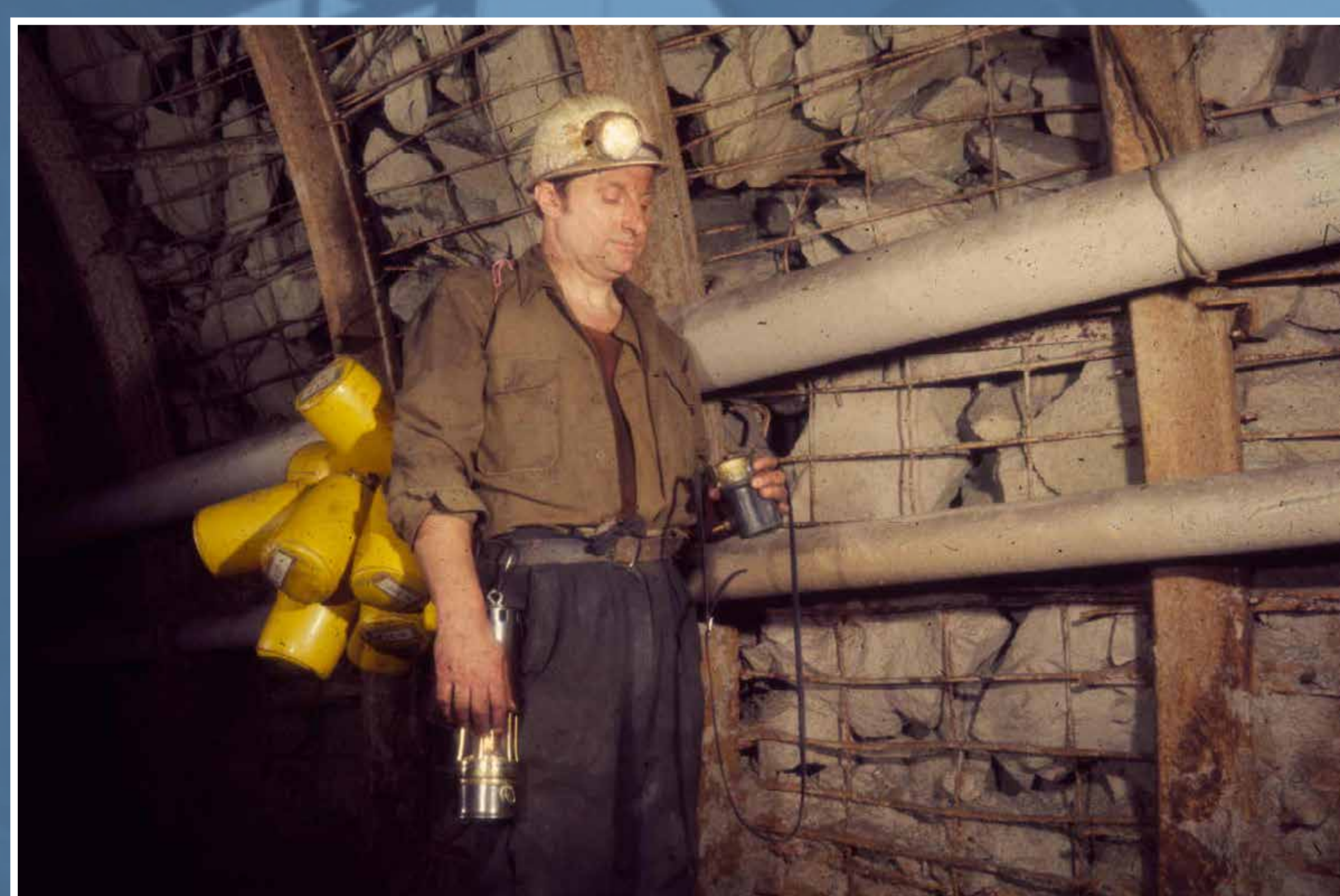
Mineur effectuant une tournée d'aérage. Mesure de la teneur en grisou grâce au grisomètre VM1 (Gilbert Friederich, 1975)
