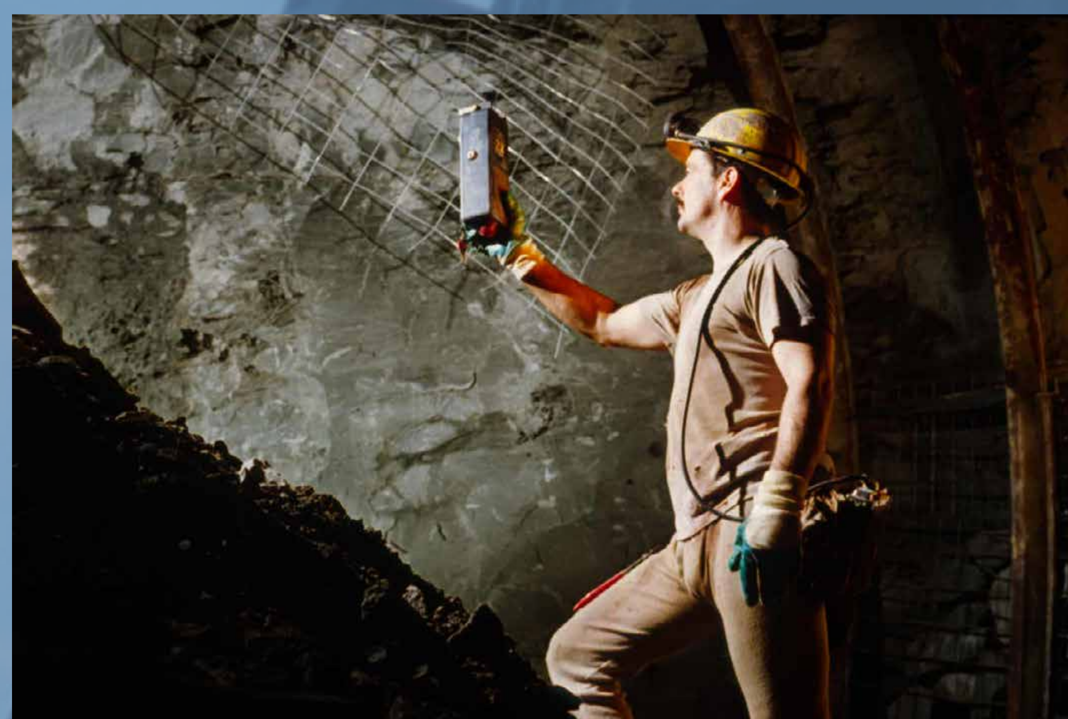
Mineur mesurant la teneur en grisou à l'aide d'une balise MSA (1995) (CAITM. Synchro. Réf. o03 486)
