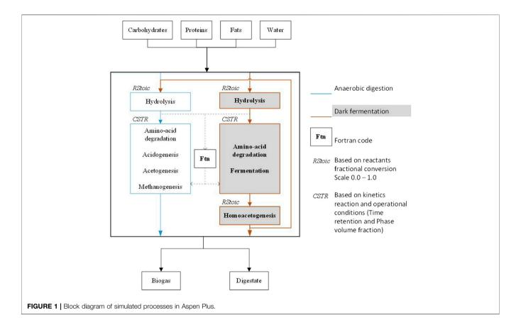
$$4H_2 + 2CO_2 \rightarrow CH_3COOH + 2H_2O \qquad \Delta G^{\circ} = 104.0 \text{ kJ/mol}$$
