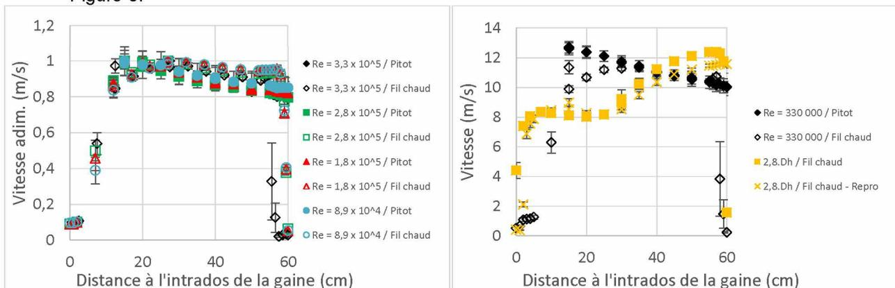
Figure 3. Profils de vitesse mesurés directement en aval de C1 pour les quatre débits d'étude et profils à 0 et 2,8.Dh en aval de C1 pour  $Re = 3,3 \times 10^5$
