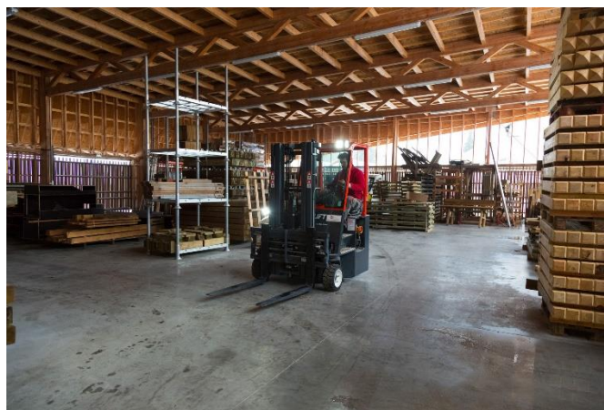
Figure 22. Atelier bois de l'ONF où le hêtre est mise en œuvre non traité en intérieure pour la structure portique lamibois, les parquets et les menuiseries, et traité en extérieur pour le bardage, Xertigny et Hadol (Terres de hêtre, nd)
