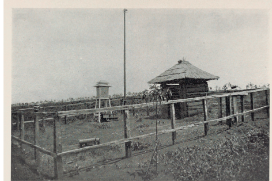
Station expérimentale du Quinquina, de Lang-Hanh (province du Haut-Donnai, Annam). La station climatologique : à gauche, le psychromètre et les thermomètres sous abris pour la température de l'air près de la surface du sol ; au fond, l'abri météorologique et la grotte sur son toit ; à droite, l'héliographe sur sa table en ciment. La station est entourée d'une forte palissade empêchant l'accès du bétail et des animaux sauvages (cerfs, etc.) ; à la porte est une cabane pouvant servir d'abri à l'observateur.
