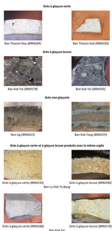
Fig. 7. Photographies des pâtes céramiques de quelques grès types (grossissement 1).
