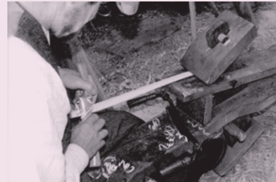
Banc d'âne à dégauchir le bois utilisé par un menuisier traditionnel à Omaru (Nouvelle-Zélande), 2007. Dans le scénario des canots de sauvetage, les savoir-faire tels que la fabrication d'outils traditionnels low-tech deviennent essentiels pour leur utilité et leur capacité à se perpétuer en l'absence de production industrielle.
