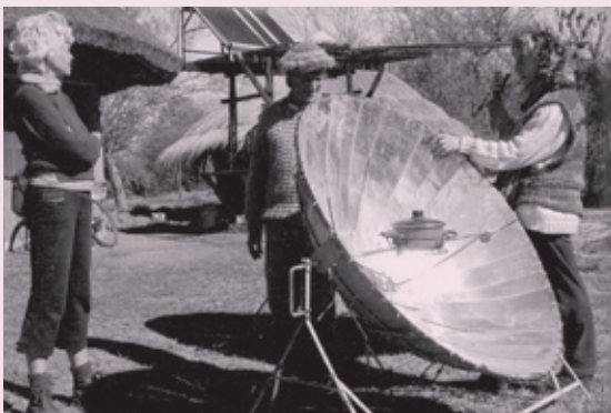
Four solaire dans l'écovillage de Gaia à Navero (Argentine), 2005. On aperçoit à l'arrière-plan un chauffe-eau solaire et la toiture en chaume du bâtiment communautaire. Dans le scénario Green tech , des technologies adaptées, simples et de petite échelle commencent à croître et à se répandre, avec ou sans soutien gouvernemental, et font partie d'un mouvement économique-politique plus général en faveur de la relocalisation.
