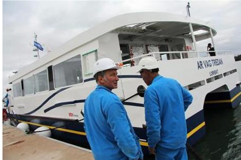
Figure 4.3 - Bateau électrique à supercondensateurs (Ar Vag Traden) http://www.supercondensateur.com/
