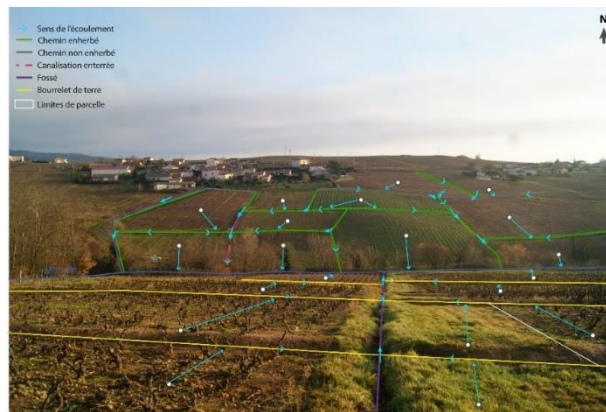
FIGURE 1. Influence des infrastructures de drainage sur les flux hydro-sédimentaires, secteur de la commune de Villié-Morgon (Beaujolais, France)
