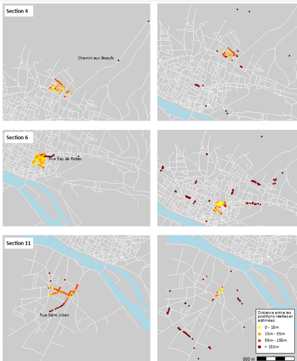
FIGURE 6 – Distance euclidienne entre les positions réelles et estimées par la méthode de positionnement proportionnel (à gauche) et par géocodage (à droite)
