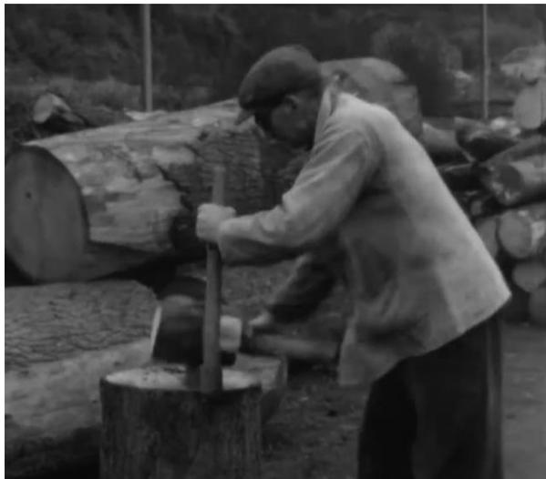
Fig. 2 : fente traditionnelle du merrain, 1956<sup>2</sup>
