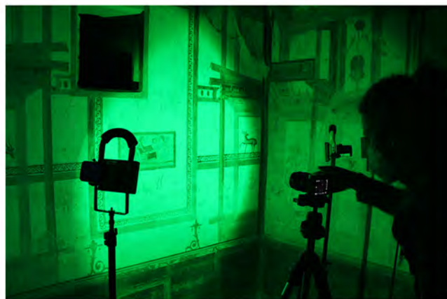
Fig. 2. Prise de photos multispectrales de nuit avec des phares à led vertes (cliché L. Guida).
