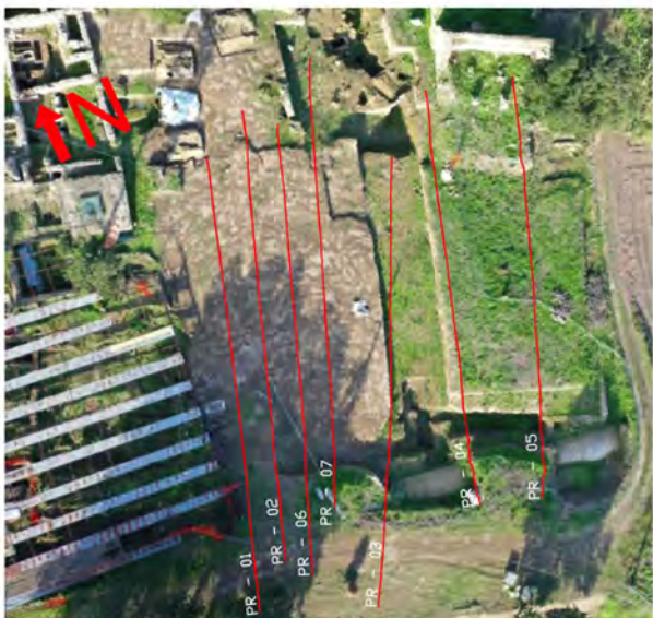
Fig. 12. Localizzazione delle differenti linee ERT nell'area di indagine.
