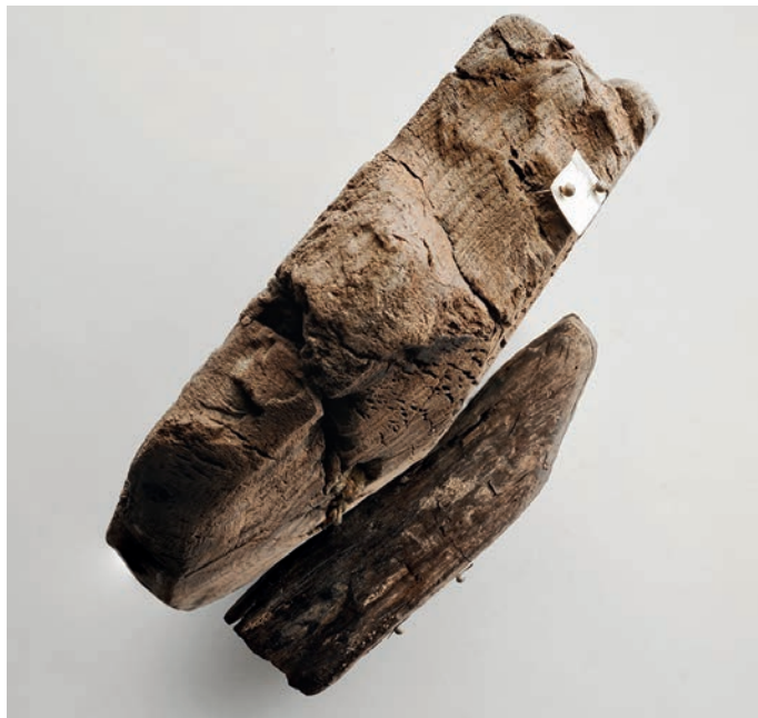
Fig. 61 – Toulon 2. Vue en section de la jonction entre la quille et la marotte (cliché L. Damelet).
