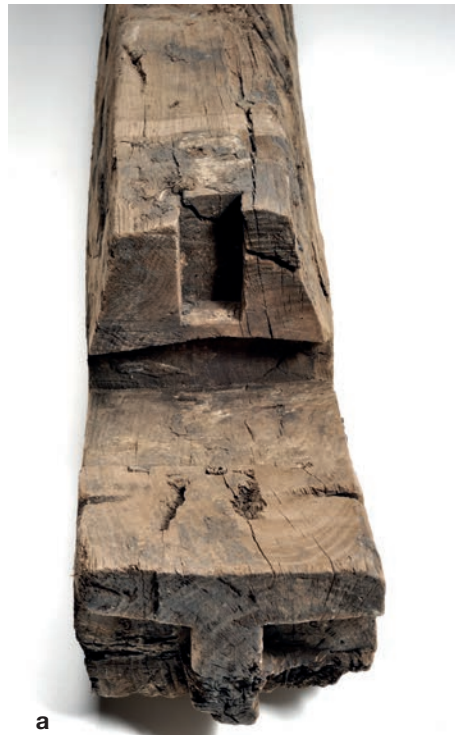
Fig. 120 – Toulon 7. L'enture en trait de Jupiter de la quille (clichés L. Damelet).
