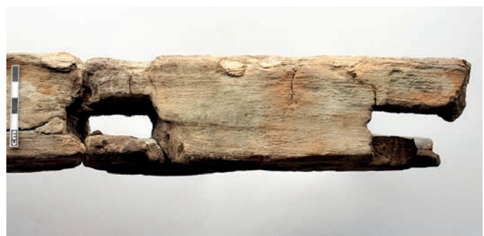
Fig. 13 – Toulon 1. Vue supérieure du fragment de préceinte avec les mortaises pour les tolets de nage (cliché L. Damelet, AMU/CNRS/MCC/CCJ).
