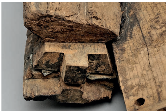
Fig. 107 – Toulon 6 . Le brion d'étrave au niveau de l'enture avec la quille (clichés L. Damelet).
