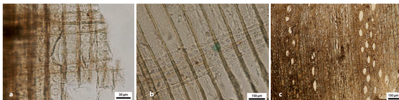
Fig. 156 – Toulon 7: a) pin type sylvestre ( Pinus t. sylvestris ) coupe transversale (éch. T7.V1); b) pin d'Alep/pin pignon ( Pinus halepensis Mill./ Pinus pinea L.) coupe radiale (éch. T7.M7); c) chêne vert/chêne kermès ( Quercus ilex sp./ Quercus coccifera L.) coupe transversale (éch. T7.tenon.V3) (clichés A. Ferreira).
