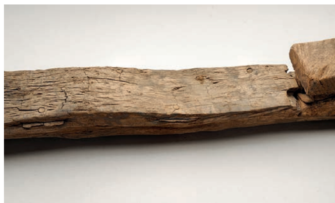
Fig. 41 – Toulon 2. La quille, à gauche, et le brion d'étambot, à droite (cliché L. Damelet).
