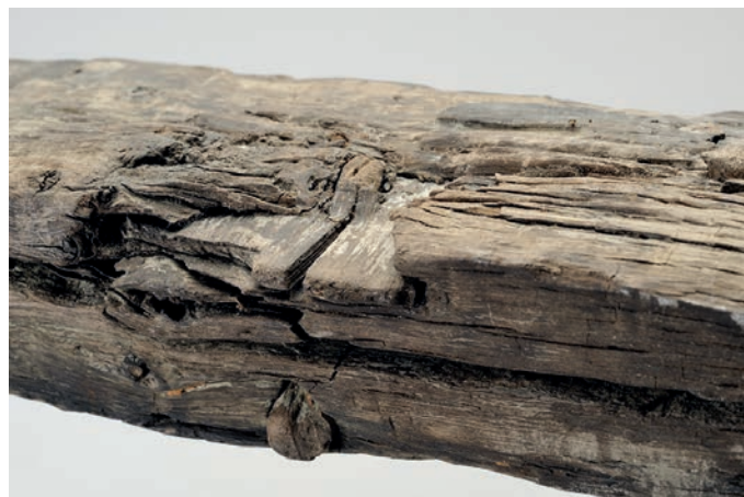
Fig. 15 – Toulon 1. Cheville oblique chassée de l'extérieur de la joue de la quille et bloquant un des tenons d'assemblage entre quille et galbord (cliché L. Damelet).
