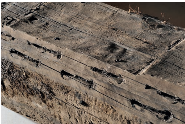
Fig. 86 – Toulon 3-4. Détail du double chanfrein de la quille (cliché L. Damelet).
