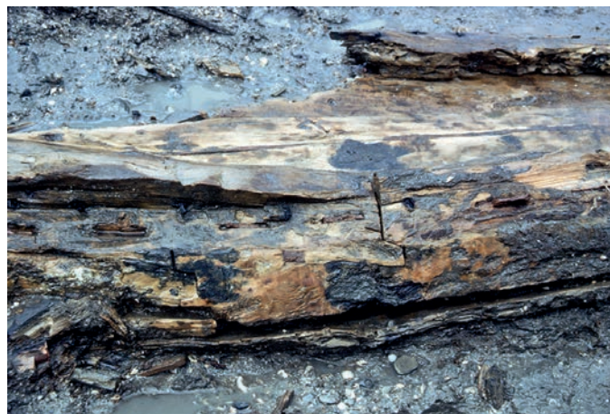
Fig. 124 – Toulon 7. La semelle de la quille au niveau de l'enture en trait de Jupiter (cliché CAV).
