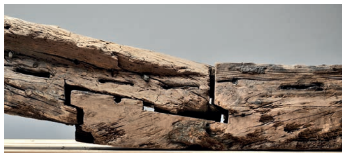
Fig. 123 – Toulon 7. L'enture unissant la quille (à droite) au brion (à gauche) (cliché L. Damelet).
