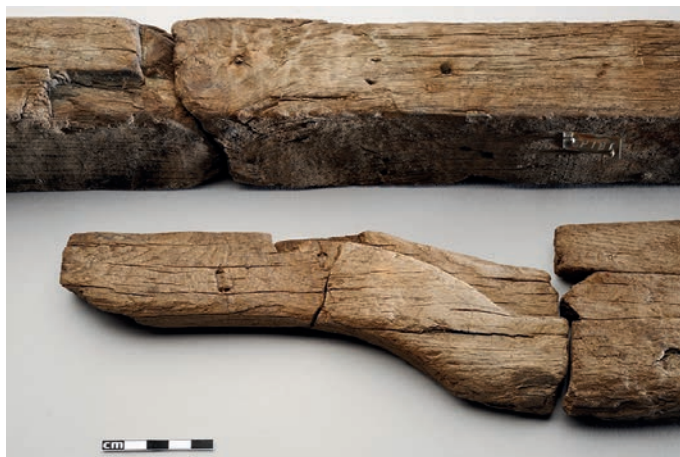
Fig. 52 – Toulon 2. Détail de l'encoche sur la face supérieure de la préceinte et qui marque l'emplacement du pavois tribord (cliché L. Damelet).
