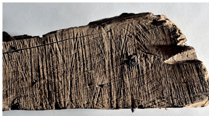
Fig. 130 – Toulon 7. Traces de scie sur la joue de la membrure M11 (cliché L. Damelet).
