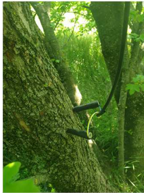
Electrodes connectées au capteur (arbre)
