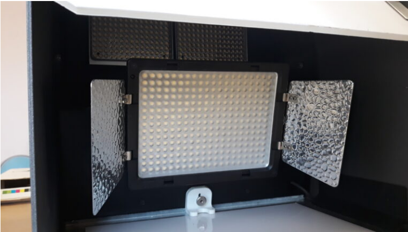
Figure 1b : vue sur l'éclairage à LED, avec une partie supérieure composée de deux lampes et une partie inférieure composée d'une seule lampe, accompagnée de panneaux réfléchissants
