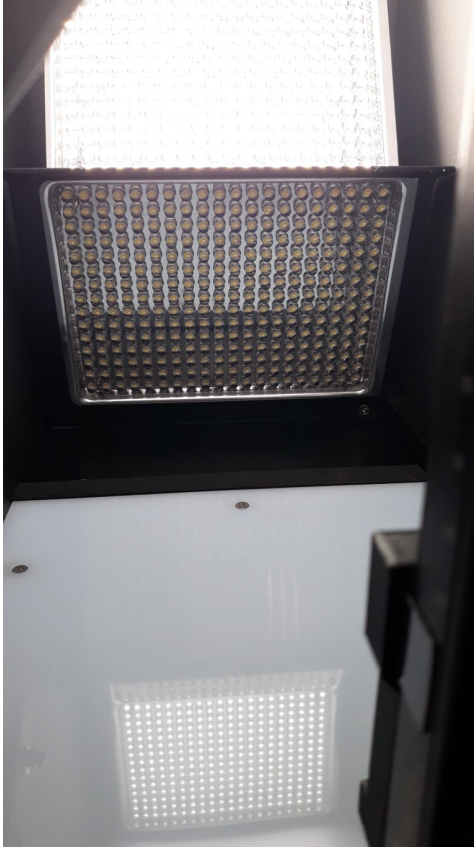
Figures 2b : vue sur l'éclairage à LED composé de deux lampes superposées
