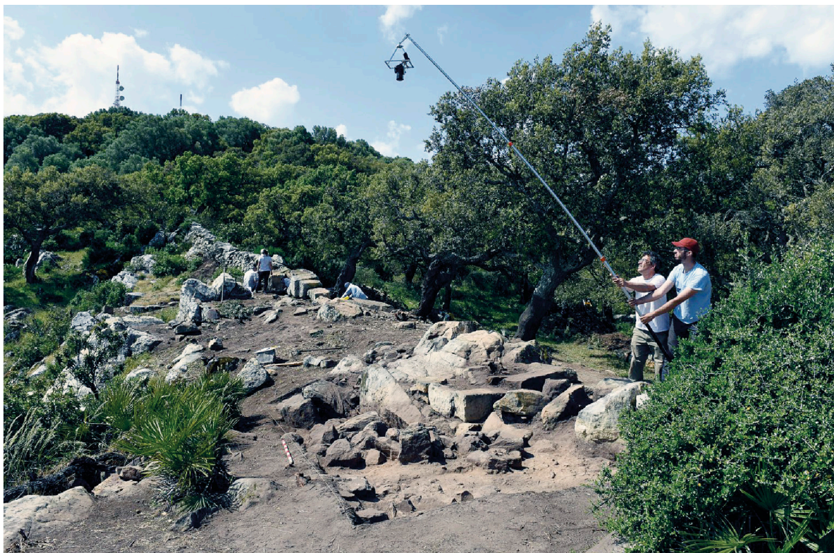
Figure 3. Photogrammétrie des monuments funéraires de la nécropole nord à l'aide d'une perche
