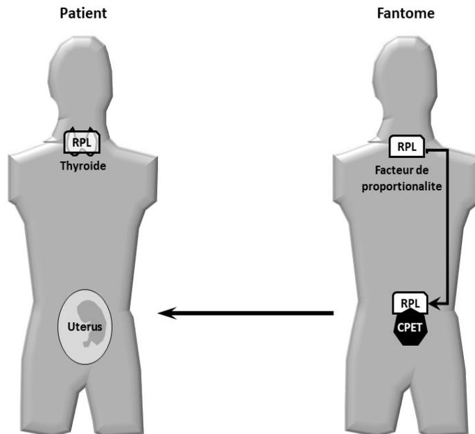
Légende: Dosimètre radiophotoluminescent RPL ( $\gamma$ ) pour dosimétrie passive (à lecture différée); microdosimètre Compteur Proportionnel Equivalent-Tissu CPET ( $n, \gamma$ ) (détecteur);
