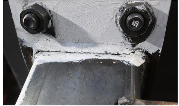
b- Weld tearing
