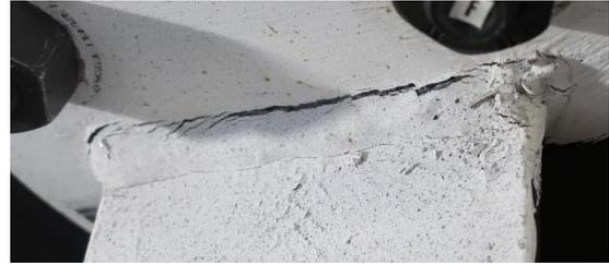
*b- Weld tearing*
