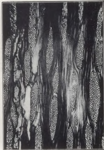
Section tangentielle. Localisation de la bakélite dans les vaisseaux. G = 60.
