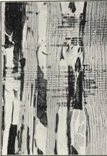
Section radiale. Localisation de la bakélite dans les vaisseaux, certaines cellules de parenchyme et des rayons médullaires. G = 60. Coloration à la chrysoïdine.
