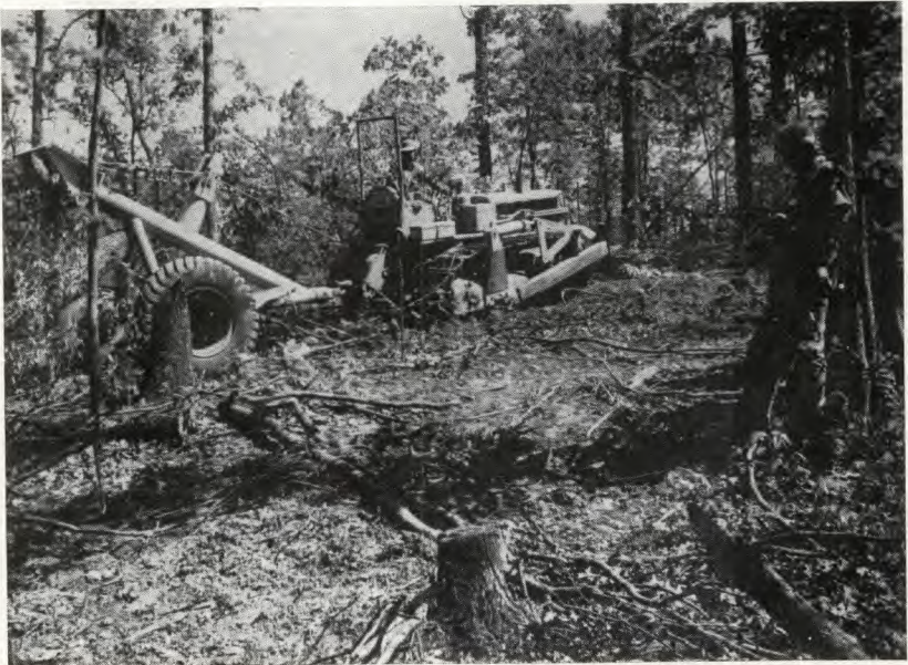
FIG. 29. Tracteur « Sully » pour la vidange des coupes. Kaskaskia Experimental Forest (Illinois).
