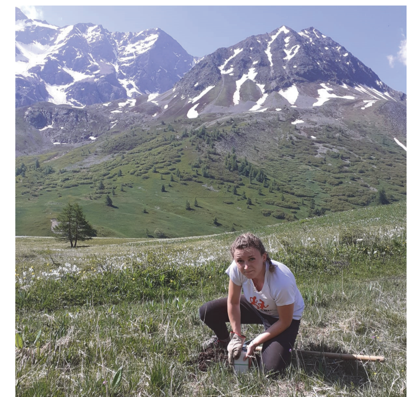
Les nodes « SmartSolo » (1,7 kg contre 14 kg pour les sismomètres CMG6-TD et leurs accessoires) permettent une mise en œuvre plus rapide et présentent un encombrement total beaucoup plus réduit. Ils permettent notamment d'aller installer les réseaux en vélo !
