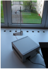
Spectromètre Ulysse avec sa fibre optique pointée vers le ciel
