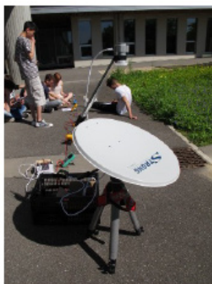
Image 1. Mesure du diamètre apparent du Soleil en lumière visible et à 10 GHz
