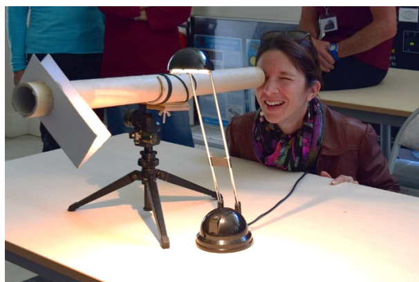
Image 1. stagiaire mesurant la distance angulaire Jupiter/satellite Europe avec une maquette de micromètre de Galilée et un visuel sur une projection vidéo, dans la salle « NEF » de l'OCA.
