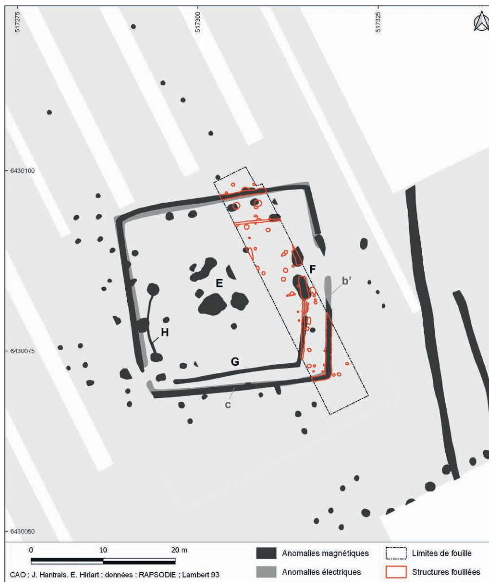
Figure 8 : Carte de synthèse des prospections géophysiques confrontées aux données de fouille (CAO : J. Hantrais, E. Hiriart).
