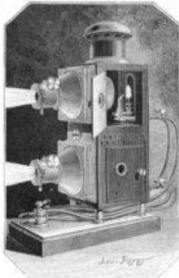
Fig. 6. Appareil de projection à lumière cathodique, préparé par Basili, destiné pour les cours.
