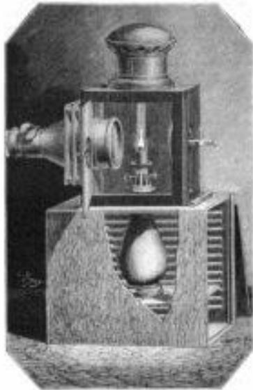
Fig. 5. Appareil de projection de Basili, fonctionnant à l'aide d'une lampe ordinaire.
