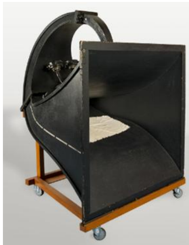
Figure 1 Enceinte type "HORN" de Western-Electric 1927. Cinématique française. ©DR
