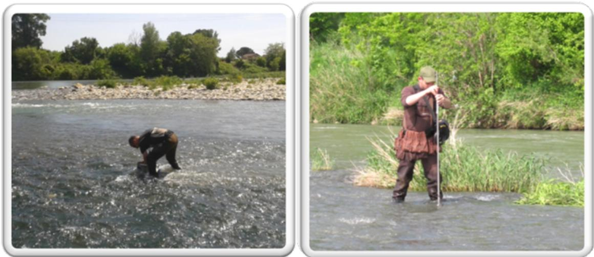
Photo5. 1-2 - Photo 5.1, à gauche, échantillonnage au cylindre de Hess (Montélimar, 24/04/2014). Photo 5.2, à droite, mesure de vitesse moyenne (Montélimar, 27/05/2012).
