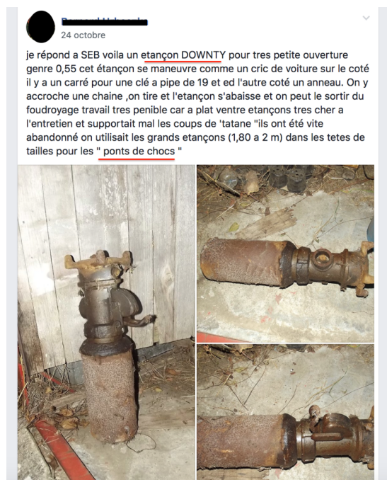
FIG. 3 : Fonction de l'étançon, publiée par un ancien mineur
