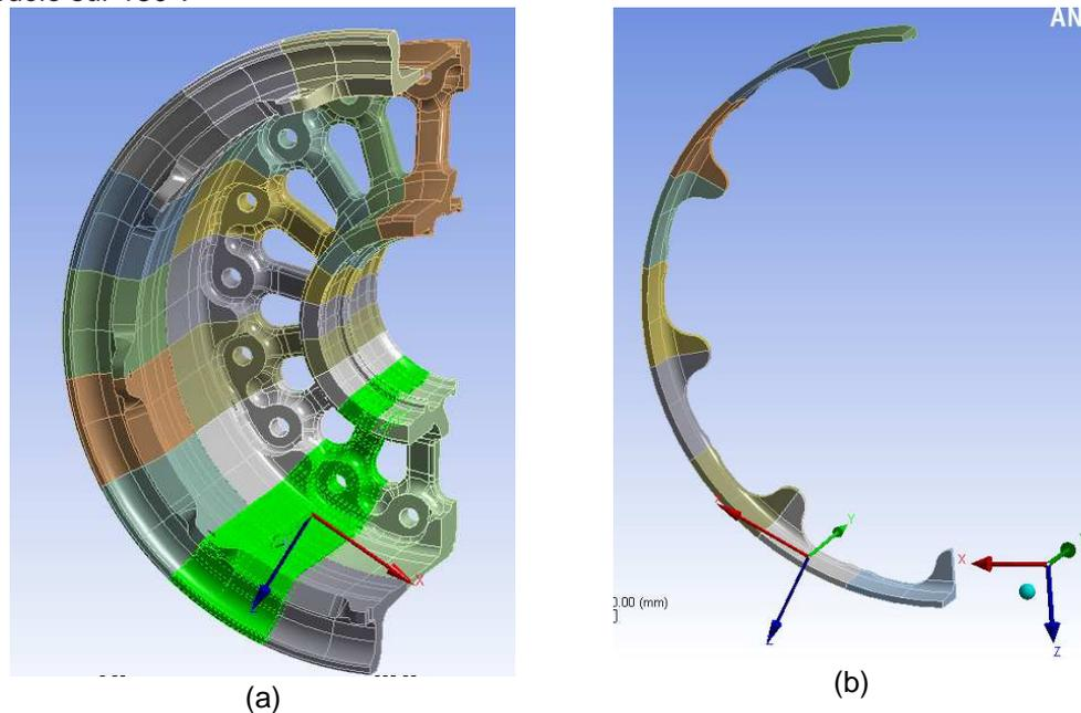
Figure 20 : modèle complet et sous modèle sur 180°
