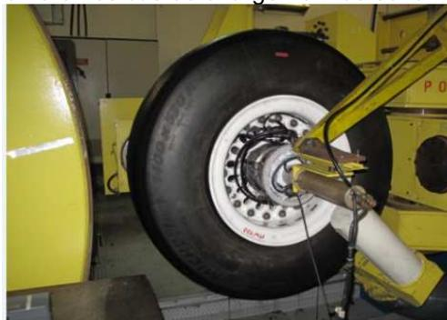
Figure 14 : Vue du montage d'essai et géométrie simplifiée
