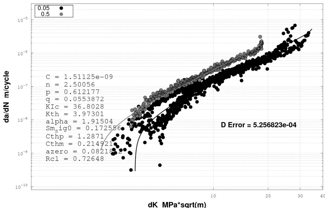
Figure 18 : Modèle de Forman-Mettu et données expérimentales
