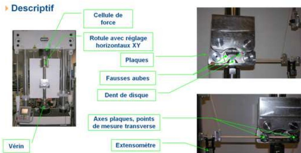
Figure 8 : Description détaillée du montage de l'essai technologique
