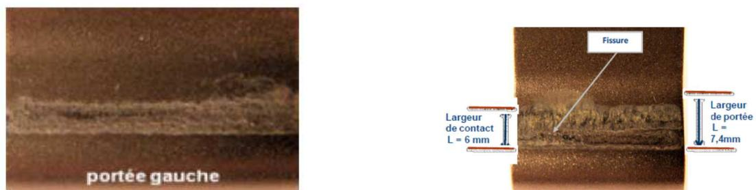
Figure 6: Photographie de portée de dent de disque après essai : dissymétrie entre les portées gauche et droite (usure plus locale à gauche)
