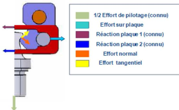
Figure 9: Chargement sur le dispositif d'essai
