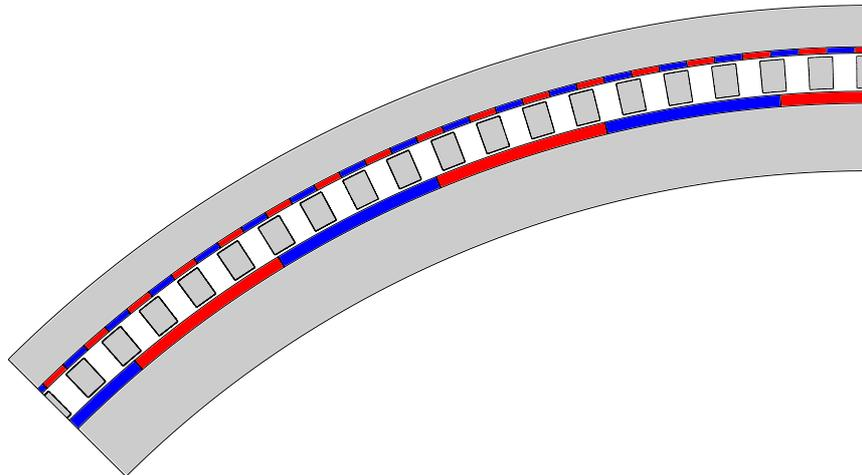
**Fig. 3.** Représentation en coupe des parties magnétiques de la structure étudiée (3.9 MW 15 tr/min [4]) :  $p_{int} = 20$ ,  $p_{ext} = 131$  et  $Q = 151$ , diamètre extérieur = 3.8 m et longueur = 2 m (perpendiculairement à la coupe).
