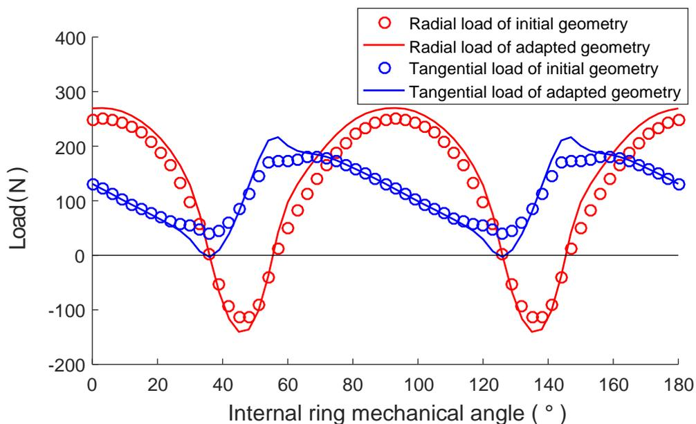
**Fig. 6** Comparaison des profils de chargement magnétique, obtenus à partir de calculs éléments finis en magnétostatique 2D, entre la géométrie de la couronne de plots initiale et la géométrie de la couronne de plots adaptée aux barres porteuses de l'engrenage magnétique (avec  $p_{int} = 2$ ,  $p_{ext} = 7$  et  $Q = 9$ ).
