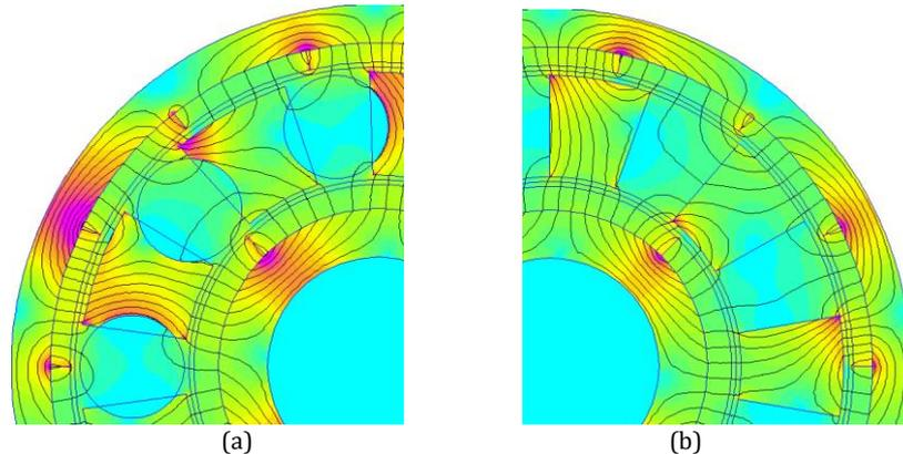
**Fig. 5** Répartition du champ magnétique obtenue par calcul éléments finis magnétique 2-D de la géométrie (a) prenant en compte l'adaptation de la géométrie des plots (b) initiale des plots pour un engrenage magnétique avec  $p_{int} = 2$ ,  $p_{ext} = 7$  et  $Q = 9$ .
