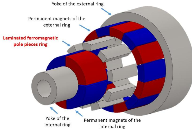
**Fig. 2.** Architecture étudiée de multiplicateur magnétique en vue éclatée avec un faible nombre de pôles (ici :  $p_{int} = 2$ ,  $p_{ext} = 7$  et  $Q = 9$ ). Seules les parties magnétiques sont représentées (aimants en bleu et rouge, zones ferromagnétiques en gris).
