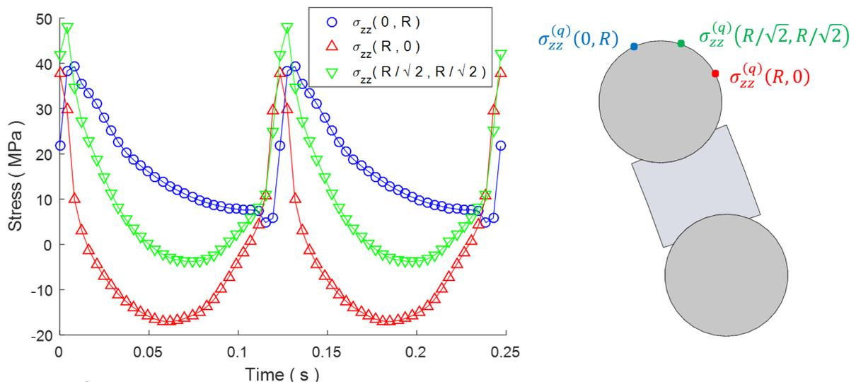
**Fig. 10.** Évolution de la contrainte normale au niveau de l'encastrement de la barre porteuse pour différents points sur son rayon extérieur (les points représentés correspondent aux endroits où la contrainte normale est la plus forte au niveau des barres porteuses) pour le multiplicateur [4].
