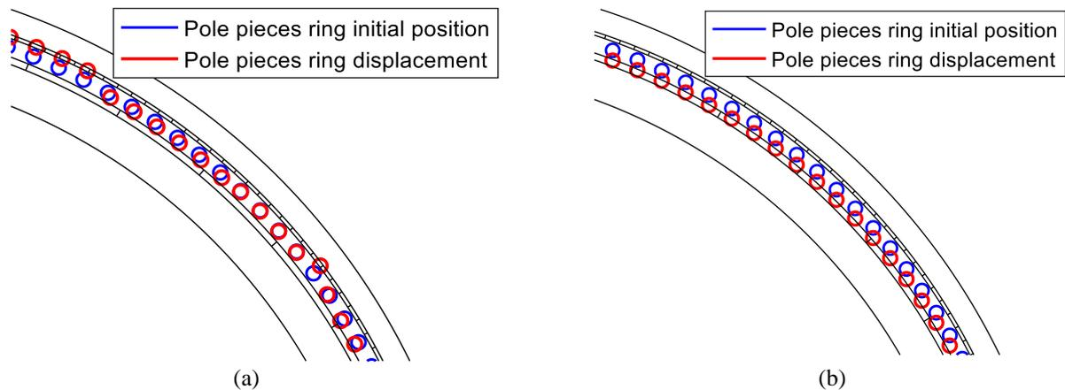
**Fig. 8** Déplacement des barres porteuses obtenue à partir du modèle multi corps (avec une amplification visuelle du déplacement (multiplication par 100)) généré par (a) le chargement magnétique et (b) le poids, pour l'engrenage magnétique étudié en [4].
