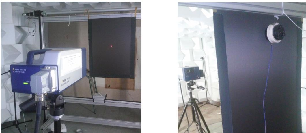
FIGURE 2 – Banc de mesure d'un multicouche en composite
