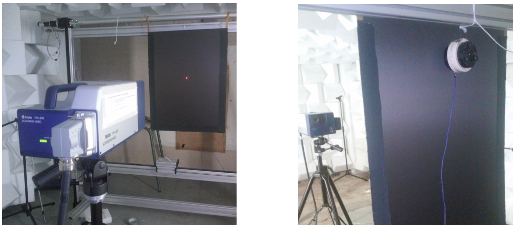
FIGURE 2 – Banc de mesure d'un multicouche en composite
