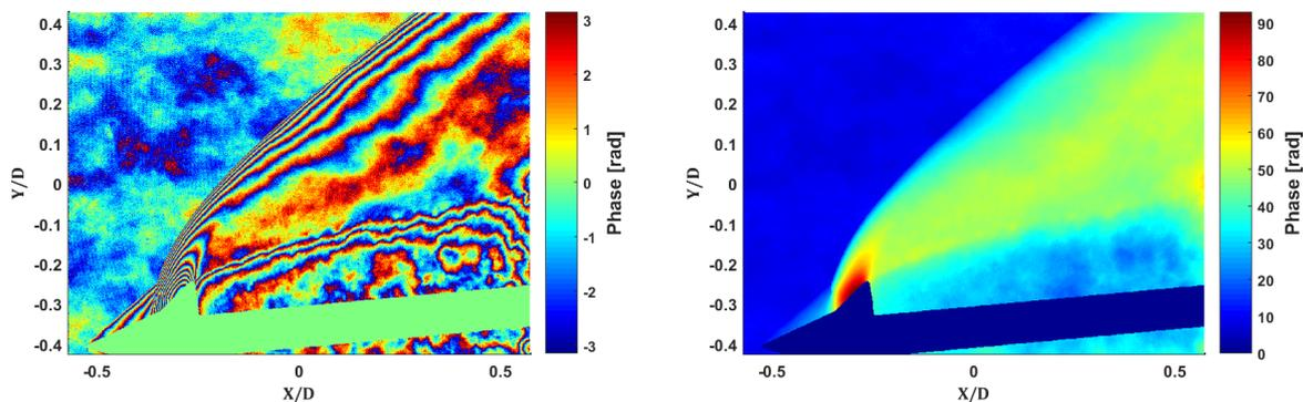
**Figure 6:** Distributions de phase pour un écoulement supersonique autour d'un spike incliné, non déplié (à gauche) et déplié (à droite).
