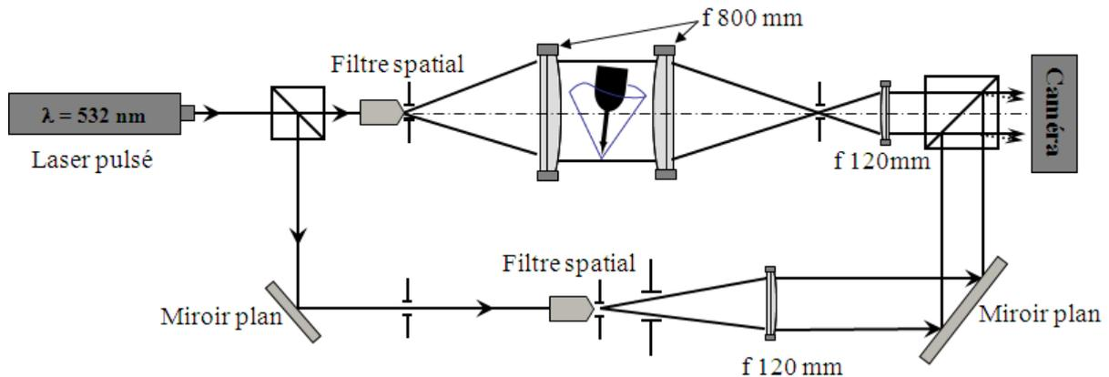
Figure 1 : Schéma expérimental du montage d'holographie numérique hors axe mis en œuvre
