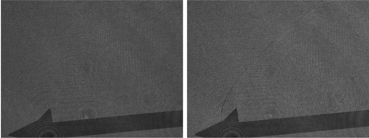
**Figure 2:** Spike axisymétrique en incidence de  $6^\circ$  par rapport à l'axe aérodynamique et en rotation de  $35^\circ$ . Interférogrammes du spike sans écoulement (à gauche) et avec écoulement supersonique (à droite).
