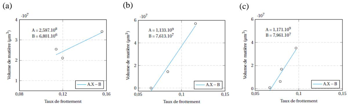
Fig.5 : Volumes des dépôts en fonction du taux de frottement (a) 20 ; (b) 100 ; (c) 200 mm.s<sup>-1</sup>
