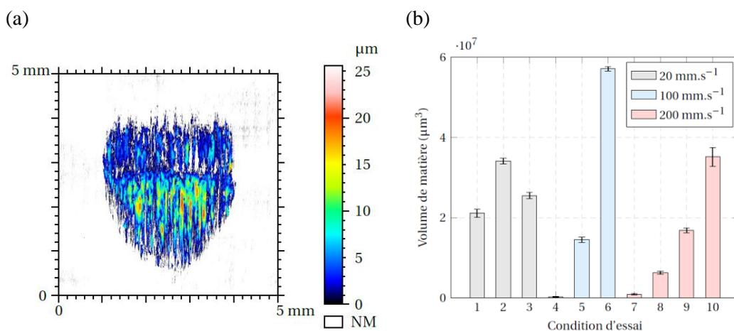
Fig.4 : (a) Topographie seuillée du 3<sup>e</sup> indenteur ; (b) Volumes des dépôts de chaque configuration.
