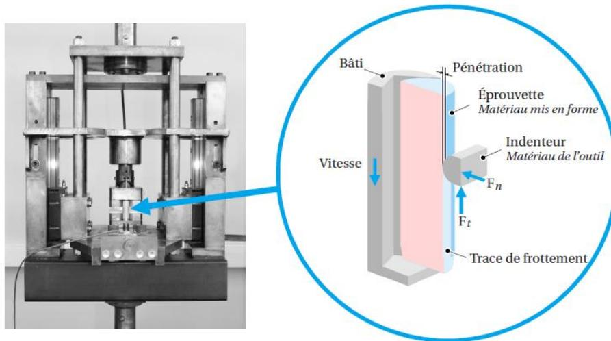
Fig.1 : Photographie du montage et principe de fonctionnement
