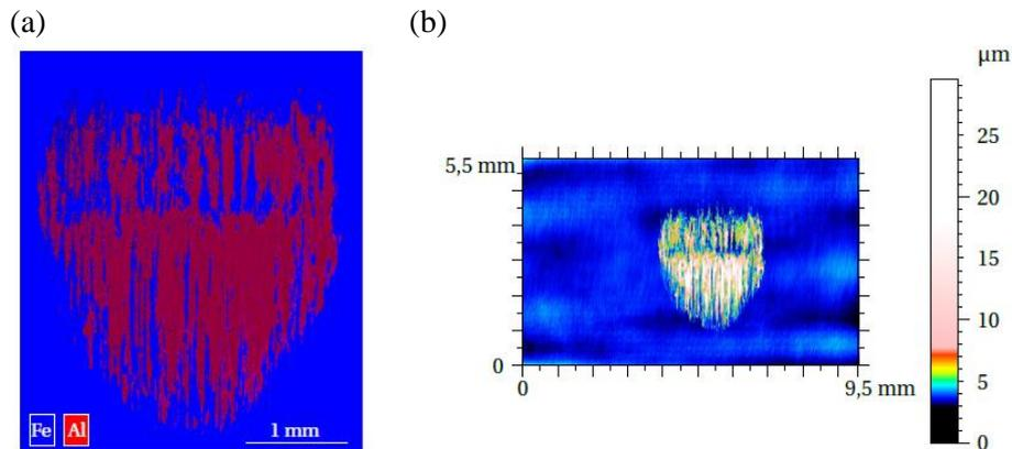
Fig.3 : (a) Analyse EDS du 3<sup>e</sup> indenteur ; (b) Relevé topographique du 3<sup>e</sup> indenteur après suppression de la forme cylindrique initiale.
