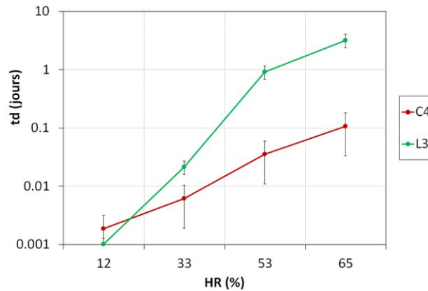
Figure 5. Temps caractéristique de la diffusion en fonction de l'humidité ambiante.
