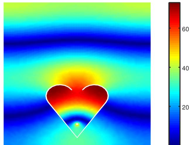
FIGURE 9 – Résultat de simulation pour la pression. Le système est excité par une sphère pulsante située dans le résonateur.
