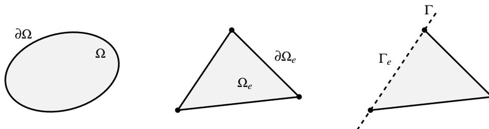
FIGURE 1 – Le domaine complet est nommé  $\Omega$  et sa frontière  $\partial\Omega$ . L'interface entre deux domaines modélisés différemment est noté  $\Gamma$ . Les indices  $e$  et  $e'$  symbolisent la restriction d'une quantité à un élément.
