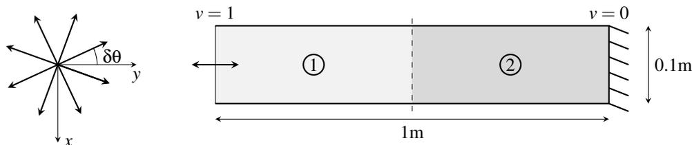
FIGURE 5 – Cavité acoustique de  $1 \times 0.1$  m excitée à gauche par une vitesse unitaire. La séparation indique la limite des domaines alloués à la MEF ou à la PWDGM. Au gauche, un exemple de directions pour une base d'ondes avec  $N_w = 8$ ,  $\delta\theta$  règle l'orientation de la première onde de la base par rapport à l'axe  $y$ .
