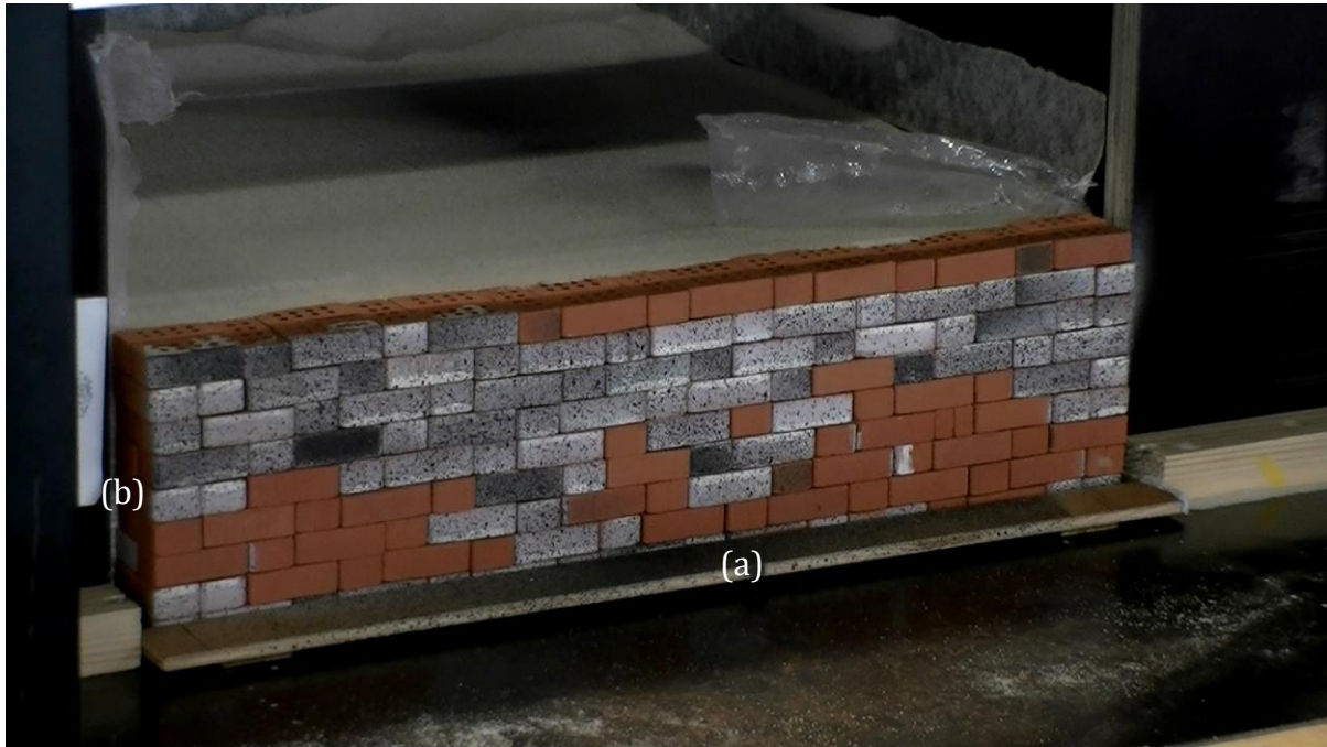
Figure 5 : Expérience d'inclinaison. (a) barre bloquant le premier lit. (b) film plastique entre le mur et les parois latérales pour retenir le sable du remblai.
