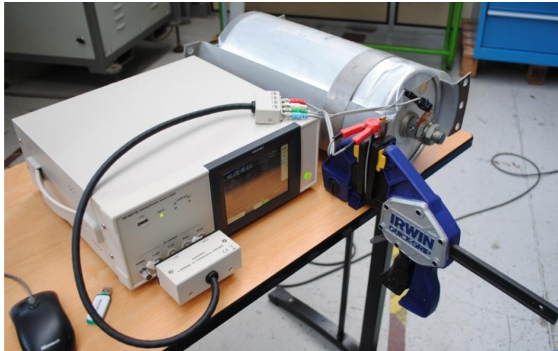
FIG. 3 – Dispositif expérimental de mesure de l'impédance d'un condensateur sur la machine Pulsar MP 25 9 , à l'aide d'un impédancemètre.
