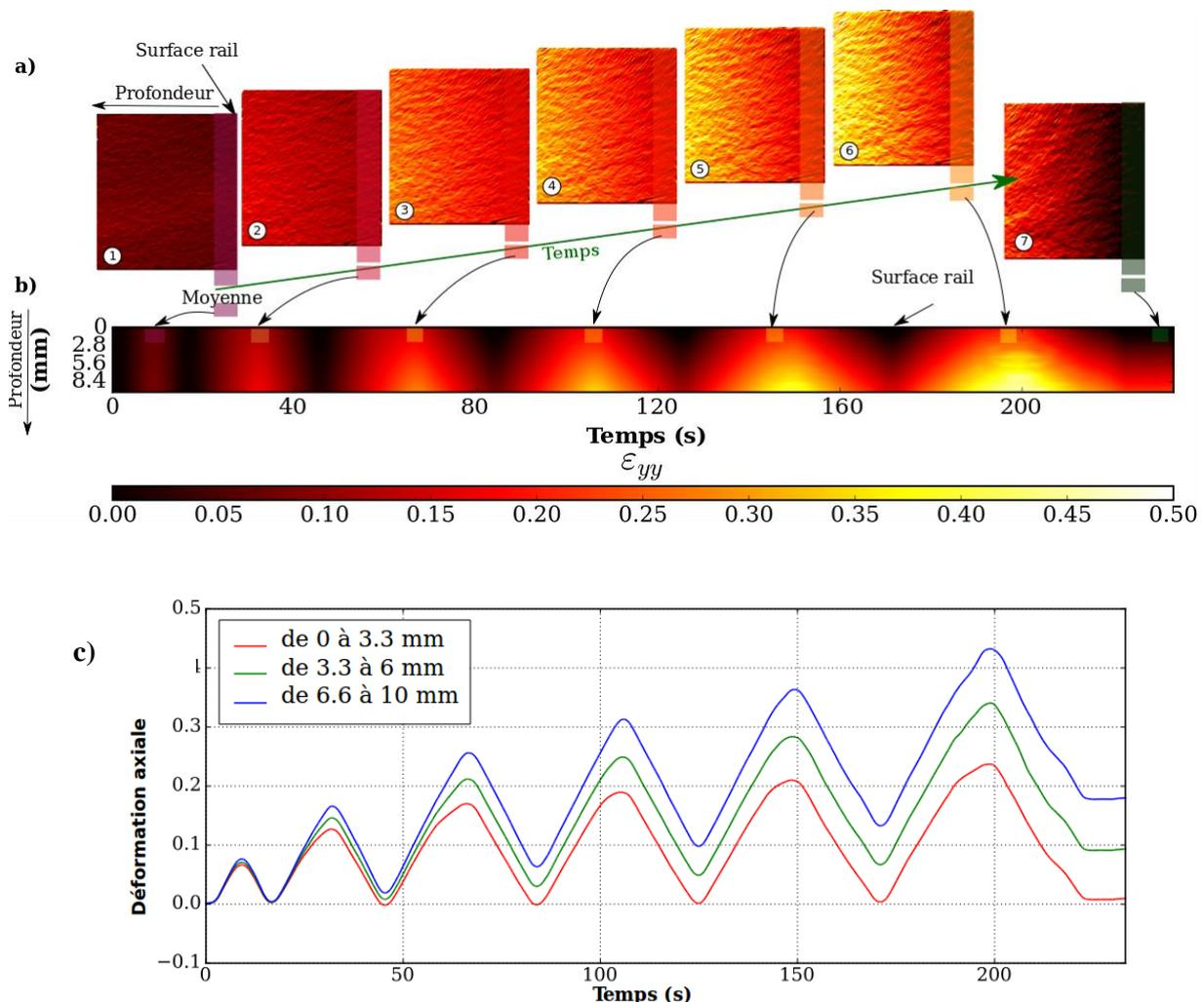
Figure 4: Méthode de caractérisation de l'influence des gradients de microstructure. a) champs de déformations axiales à différents instants, au cours de la sollicitation, repérés sur la figure 1, b) diagramme des déformations moyennes suivant la profondeur du rail, c) évolution de la déformation moyenne de 3 zones depuis la surface jusqu'en profondeur.
