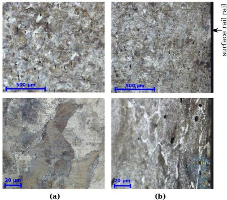
Figure 2 : Micrographies optiques de l'échantillon à 15 mois de service a) à cœur, b) en surface
