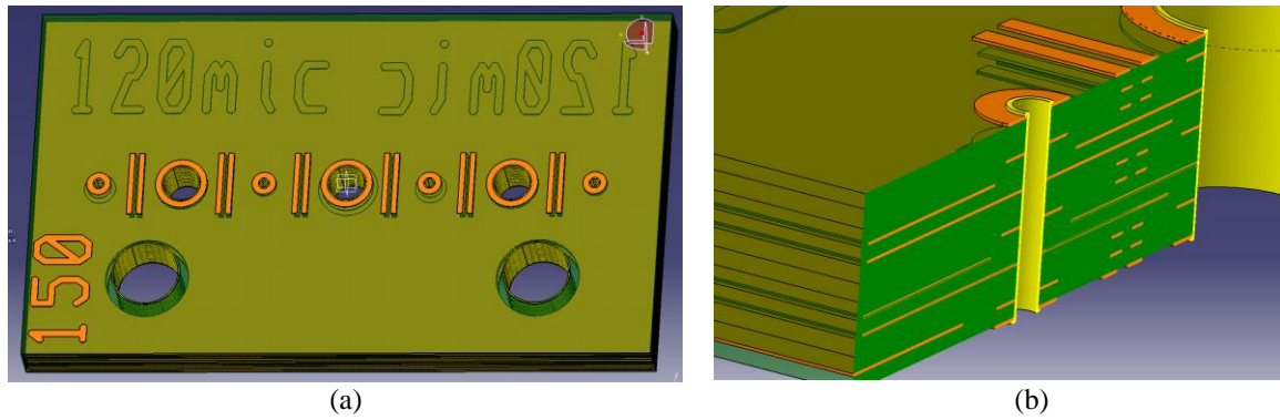
Figure 6: (a) Vue générale d'un circuit imprimé reconstruit. (b) Vue en coupe d'un trou métallisé ainsi que de la structure interne de la carte. Les éléments en cuivre sont représentés en jaune-orange.
