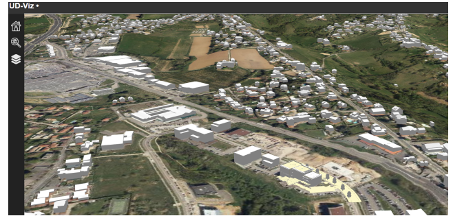
Figure 2: Vue de géométries extraites de données BIM (en jaune) et SIG (en blanc) dans UD-Viz
