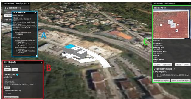
Figure 4: Visualisation d'un bâtiment provenant du BIM (en blanc) et de la sémantique associée à une dalle sélectionnée (en bleu) : dans le cadre A, information provenant de l'instance Ifc de la dalle, dans le B, information sur l'instance de la géométrie dans le 3DTiles, dans le C, le document lié à l'instance Ifc de la dalle.
