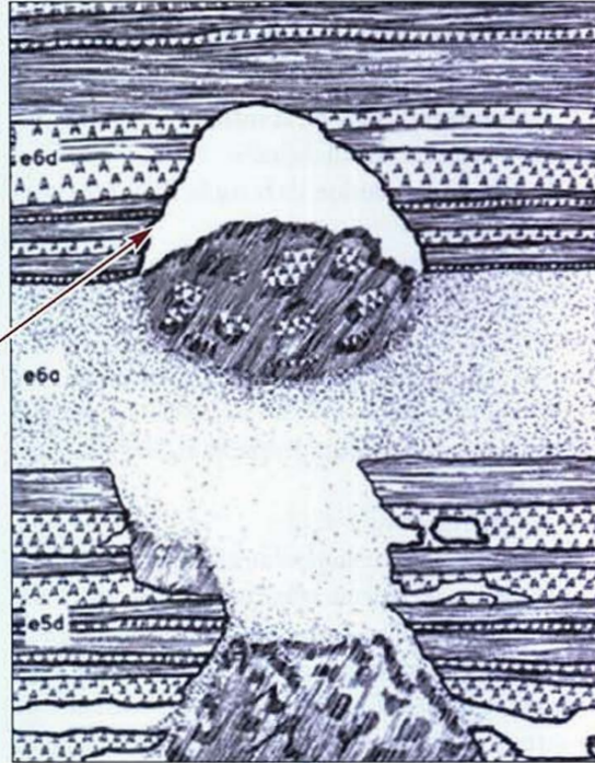
Figure 3 – Vue de la cavité de la Gare du Nord découverte en 1975 et interprétation de son évolution.
