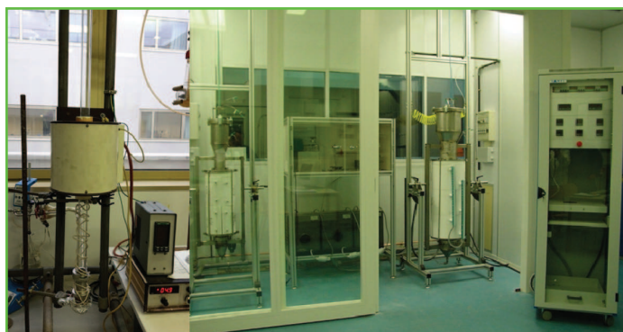
Figure 3 - Réacteurs de CCVD en lit fluidisé de 2, 5 et 16 cm de diamètre de l'Institut National Polytechnique de Toulouse.
