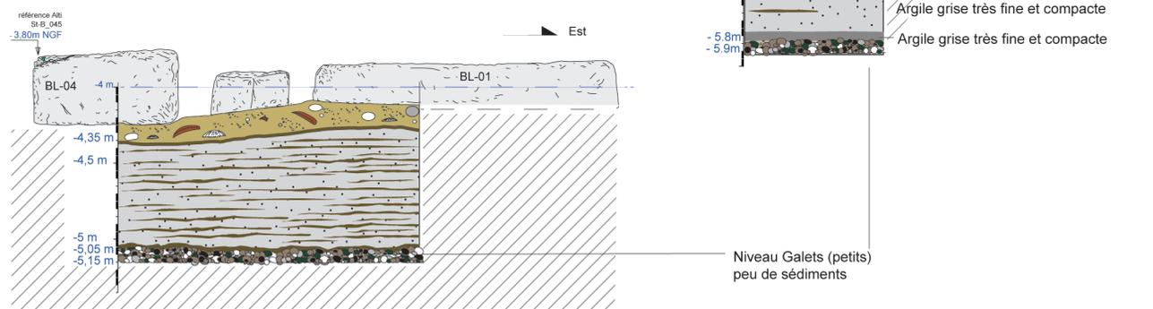
**Fig. 5** – Planimétrie des piliers PL 3 et PL 12 et relevés des coupes stratigraphiques des sondages S-B1 (PL 3) et S-B2 (PL 12) (M. El Amouri, Ipsa Facto).
