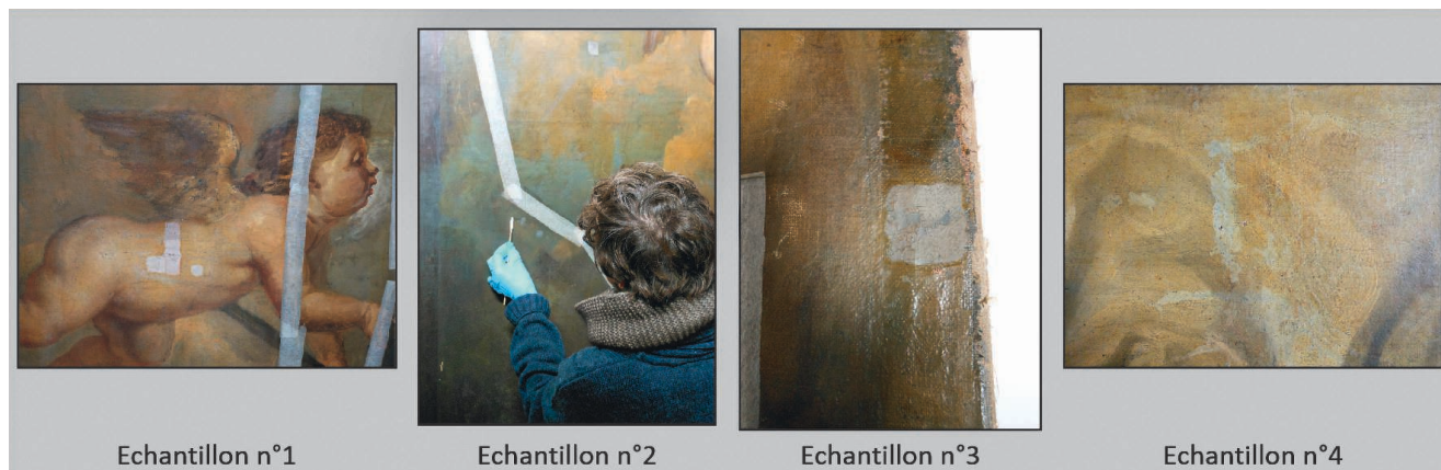
Fig. 3. Détails des échantillonnages, les zones plus claires sont celles où le vernis a été prélevé. © T. Martel.
